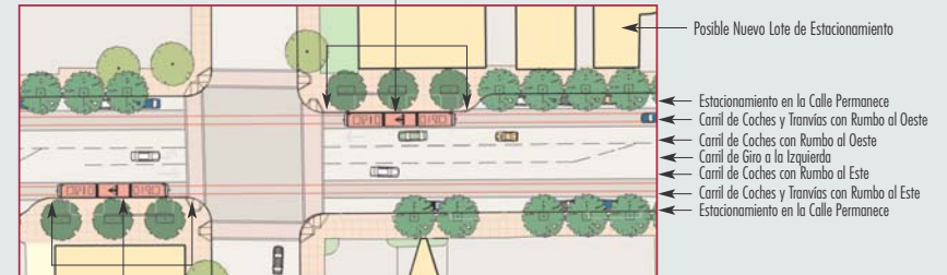
Ejemplo de plataforma de estación "añadida a la anchura" de la acera
